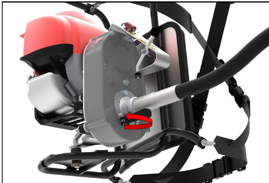
Abb. 11: Trennen des Vibrationsschlauchs
