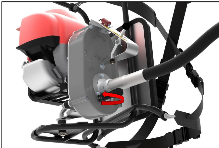
Figuur 11: Loskoppelen van trilslang
